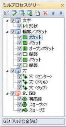
工程・定義の順序入れ替え、削除する事ができます。工程作成を行います。定義追加はアクティブ工程に対して行います。プロパティで工程・定義の設定を変更する事ができます。再定義で工程・定義の形状および設定を変更する事ができます。定義、工程のチェック ON/OFF により、画面表示、NC 生成を指定する事ができます。
